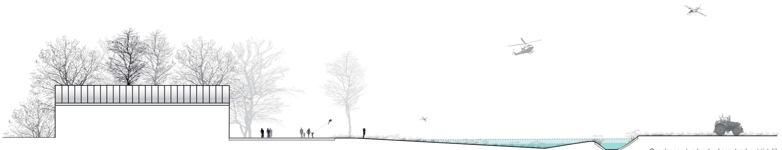
Openleggen / verbreden Langeleed met tijdelijk functionerende overstromingszone
